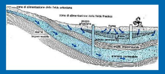
Si trovano immagazzinate in corpi rocciosi permeabili (rocce serbatoio), limitati inferiormente da rocce impermeabili (argille, marne, limi, ecc.) con funzione di substrato.
